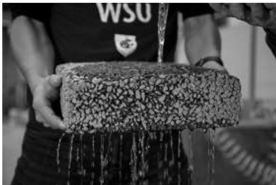
图 6.17 透水混凝土基层效果图
