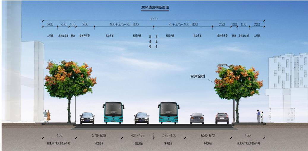
沙河东路景观绿化标准段横断面图（30米宽）
