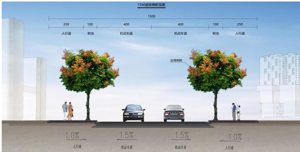
沙河东路景观绿化标准段横断面图（15米宽）
